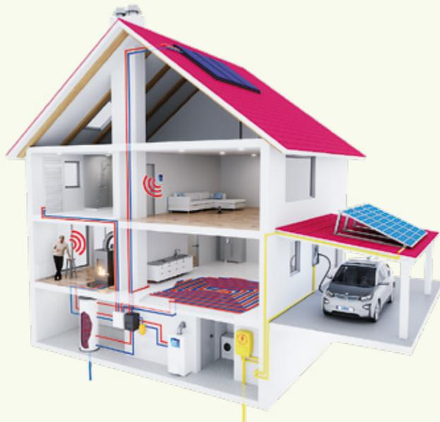
Moderne auf Zukunft ausgerichtete Gebäude ermöglichen die flexible Energieerzeugung und -nutzung, je nach Tageszeit und Verfügbarkeit. Eine mit Holz betriebene Einzelfeuerstätte lässt sich mit unterschiedlichen Heizungstechniken kombinieren. Im Zusammenspiel mit der Wärmepumpe erbringt sie vor allem bei kalten Temperaturen einen Kostendeckungsbeitrag mit erneuerbarer Energie.
